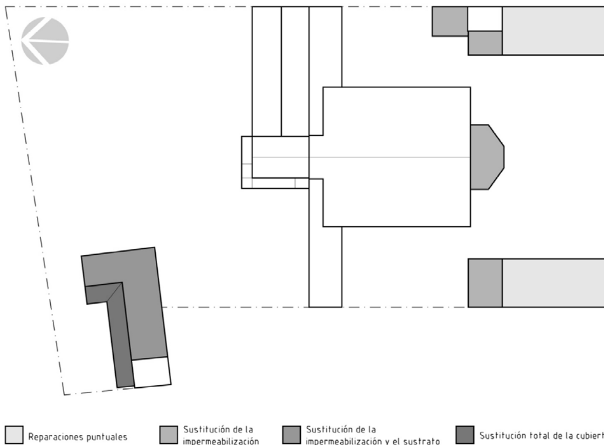
Fig. 3 - Planta de techos indicando los sectores de cubierta a intervenir y el tipo de intervención
